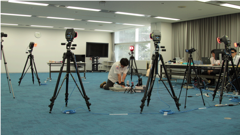
Fig.1 モーションキャプチャーによる体位変化とフォースプレートによる圧迫荷重変化を同時に計測する方法により、動的なCPR中の数値を計測しました。
