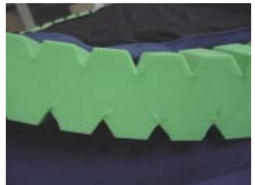
初めてのV字溝試作品。スポンジカッターが切り込みすぎている。
